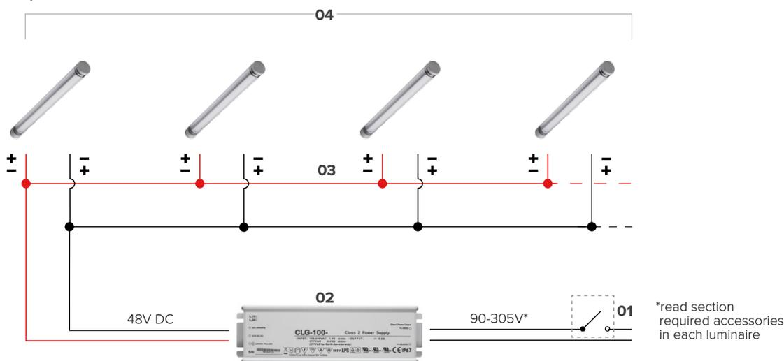
**5. SCHEMA DI COLLEGAMENTO 1-10V DIMMING O DALI: 48V DC
